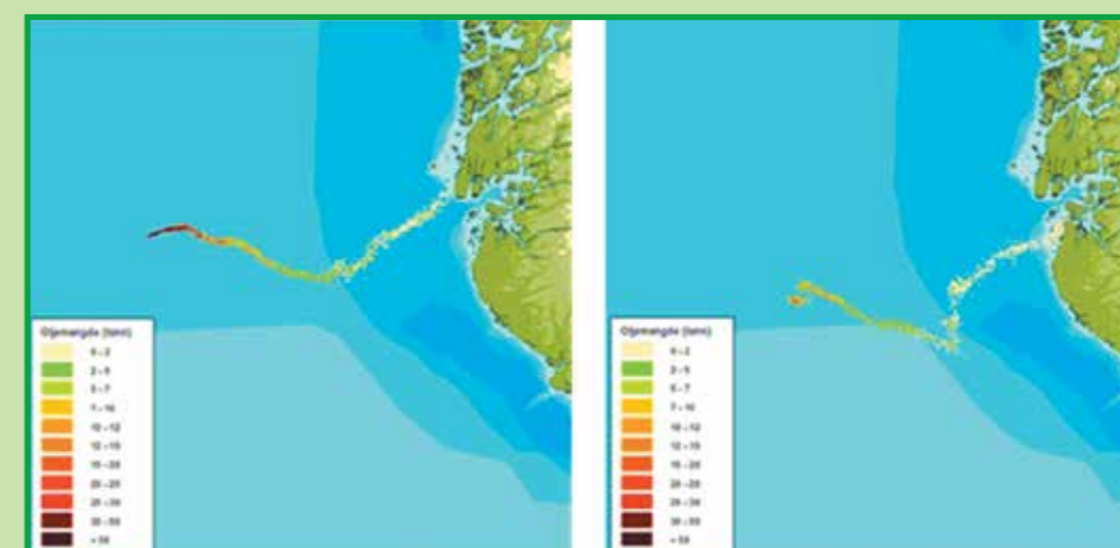
Figura 3-6 (numeração do MIRA). Quantidade de óleo na superfície do mar para uma simulação individual de deriva de óleo para 6,5 dias (esquerda) e 9 dias (direita) após o início da descarga.
