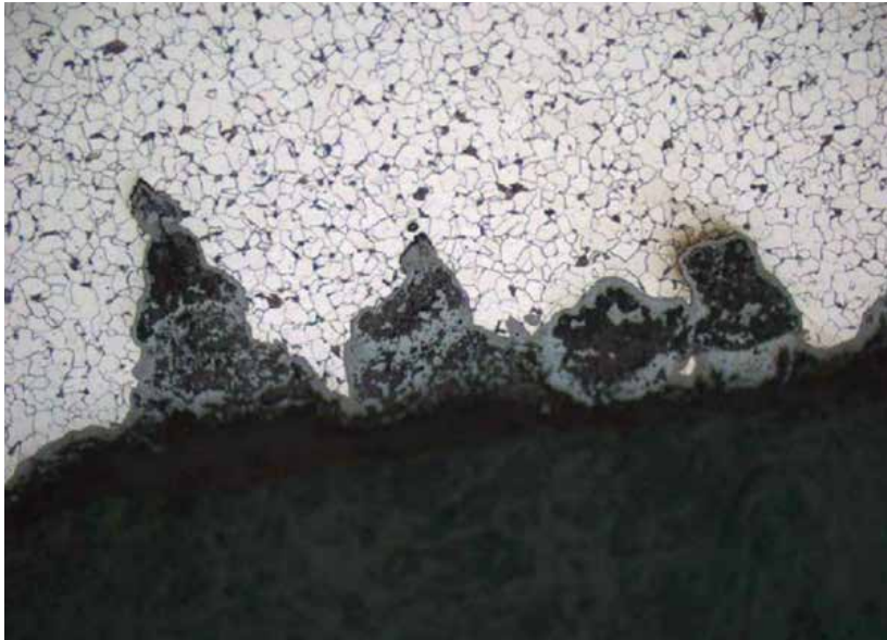
Figura 6.19 – Corpo de prova para metalografia de uma amostra retirada de um tubo com falha de uma caldeira
