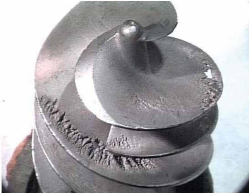
Figura 8.13 – Superfície com acúmulo de pites causado por cavitação no lado de baixa pressão de um impelidor de bomba feito em aço inoxidável
