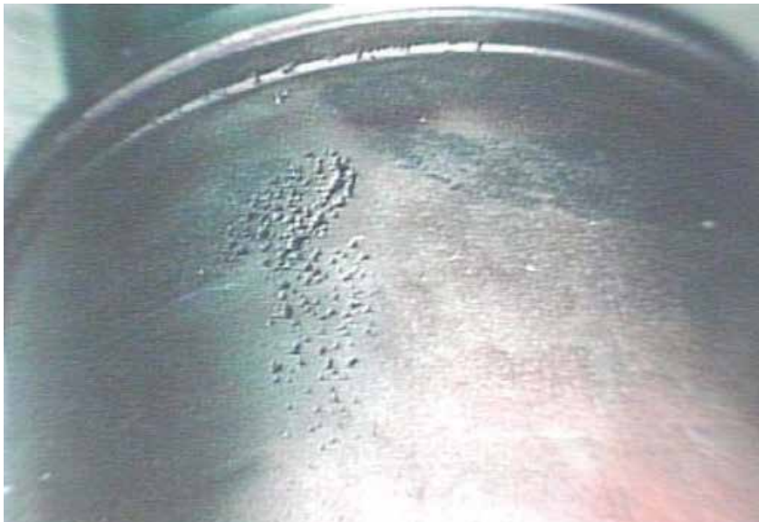
Figura 8.14 – Pites causados por cavitação no lado da água de um cilindro de ferro fundido no lado da alimentação
