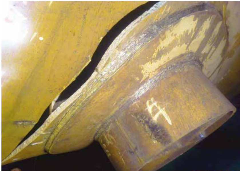
Figura 8.8 – Fratura frágil no costado de um vaso durante teste hidrostático
