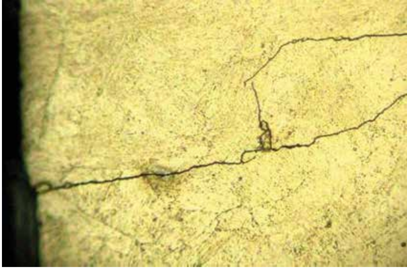
Figura 8.2 – Detalhe da trinca de fadiga
