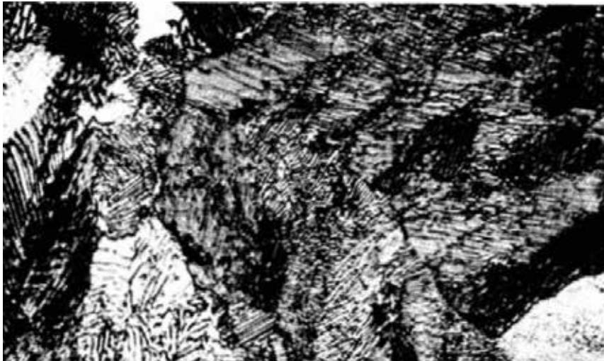
Figura 7.1 – Micrografia de aço eutetóide, cementita em forma de lamelas (regiões escuras)
