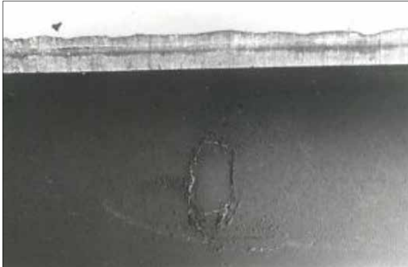
Figura 6.21 – Foto de um tubo de vapor de caldeira cortado ao longo de sua seção longitudinal. Trincas de corrosão/fadiga iniciadas na parede interna do tubo, do lado oposto da viga horizontal inferior de reforço na parte externa do tubo
