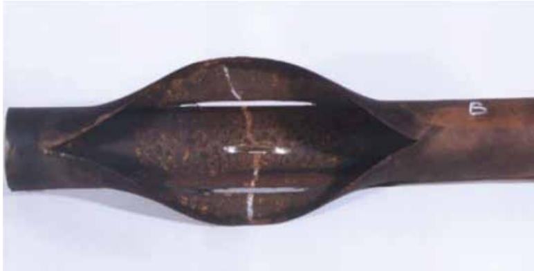
Figura 10.2 – Tubo com protuberância e rompido prematuramente por sobreaquecimento a temperatura bem acima de 750°C
