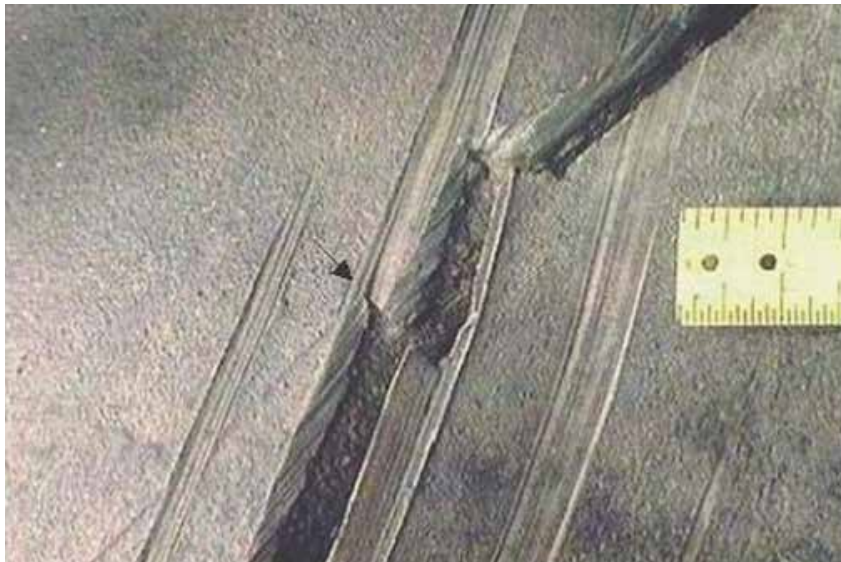
Figura 8.6 – Detalhe da figura 8.5 mostrando as ranhuras e a origem da fratura (seta) em uma das ranhuras
