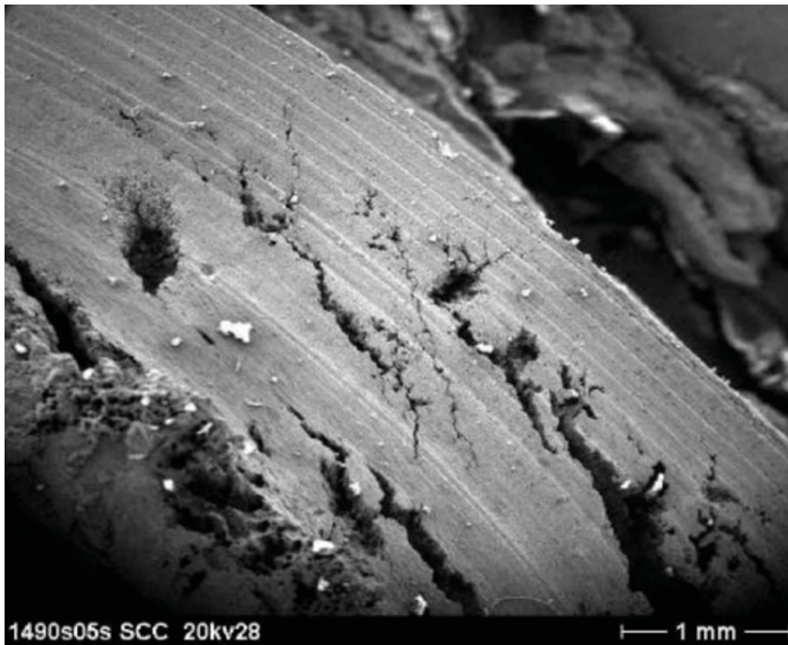
Figura 6.28 – Ataque de corrosão sob tensão por cloretos na superfície dos fios de um parafuso em aço inoxidável 304
