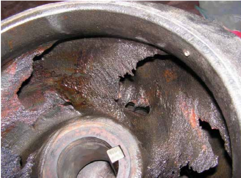
Figura 6.13 – Corrosão/erosão de um impelidor de bomba de reciclo de água feito em material ASTM A48 Classe 30
