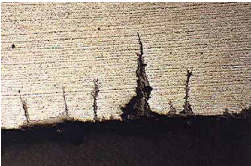
Figura 8.4 – Trincas de fadiga térmica
