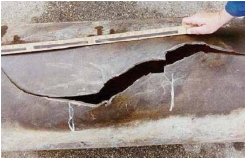
Figura 8.5 – Tubo de 500mm de diâmetro que falhou durante teste hidrostático a partir de ranhuras superficiais
