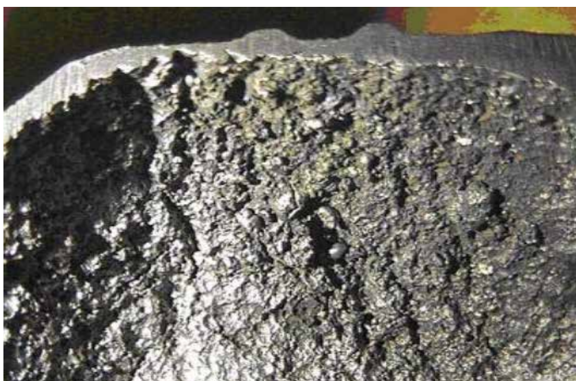
Figura 8.12 – Vista aproximada do dano na superfície da válvula borboleta da figura 8.11
